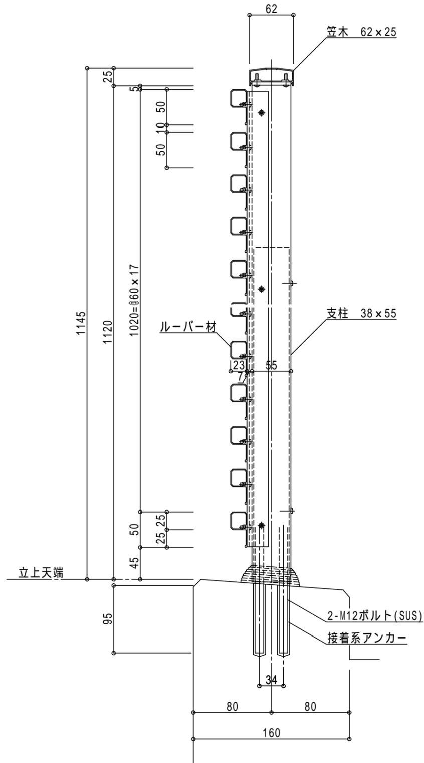
\* 鉄筋がボルトに干渉しない様に配筋願います。
