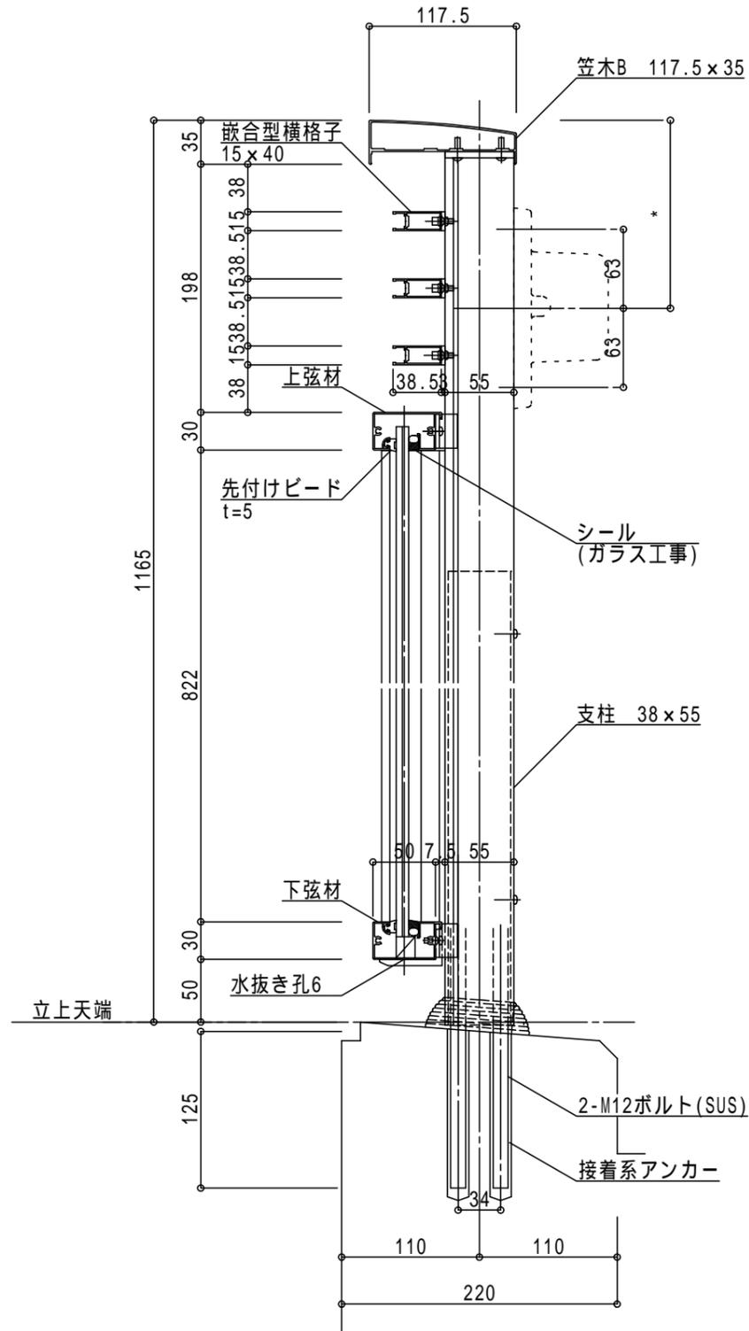
\* 鉄筋がボルトに干渉しない様に配筋願います。
